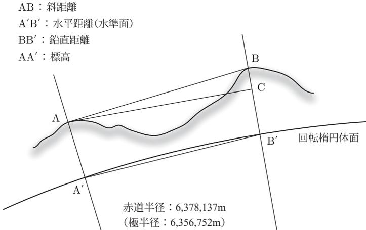
図 1.2 測定距離が長い場合の水平距離
