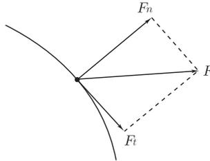
図 1.2 法線応力  $F_n$  と接線応力  $F_t$
