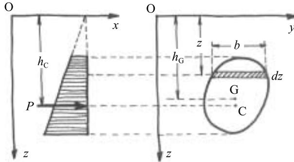
図 2.10 鉛直平面の静水圧
