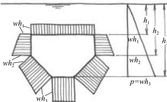
図 2.9 固体表面の静水圧
